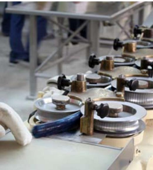
Nach dem Abkühlen und der Qualitätskontrolle werden die ausgehärteten Lollis in die Wickelmaschine gefüllt (siehe Foto) und mit einer Geschwindigkeit von 200 Lollis pro Minute in eine speziellen Arminia-Folie gewickelt und verpackt.
